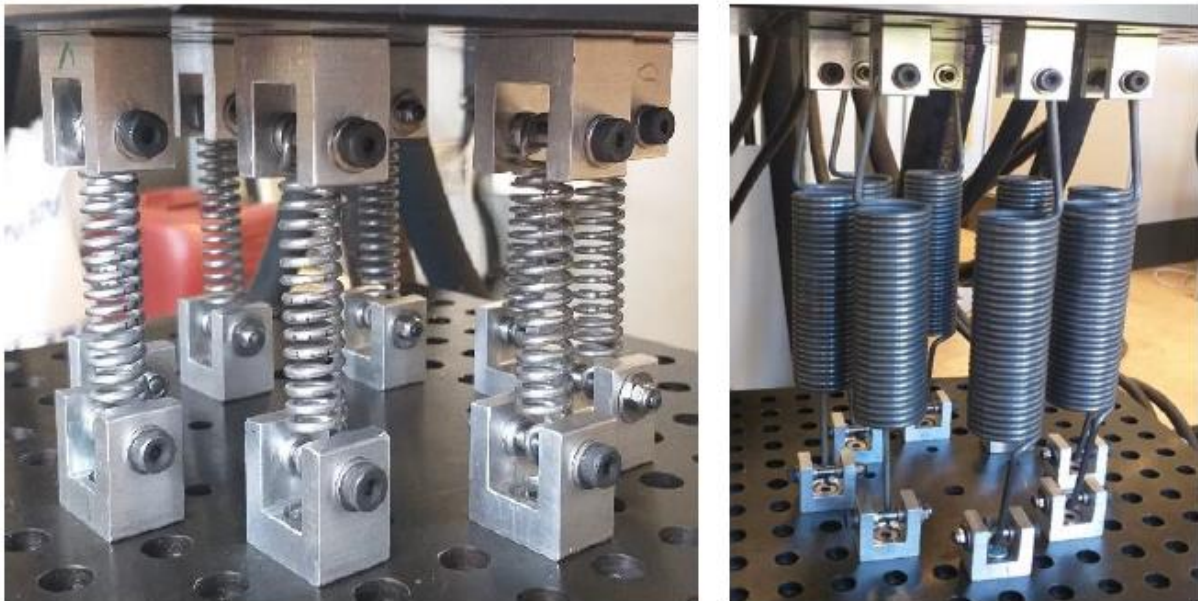
Bild 2-20: Vorrichtungskonzept zur Prüfung des Zugfedern
