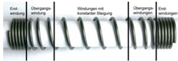
Windungsteile einer Druckfeder
